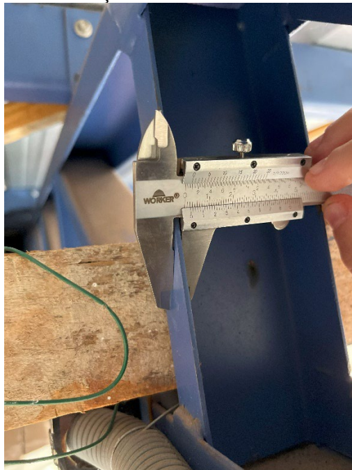
Figura 7 - Aferição das dimensões dos montantes
