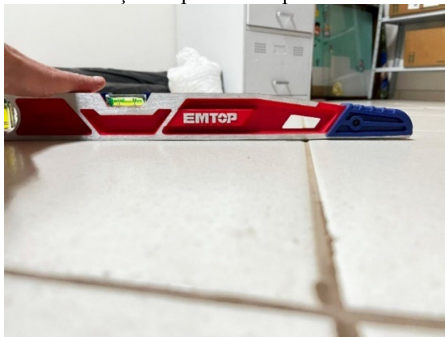
Figura 37 - Verificação da planeza do piso cerâmico no Arquivo
