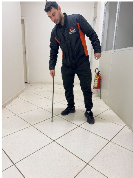
Figura 36 - Ensaio de percussão em piso cerâmico da circulação do pavimento térreo
