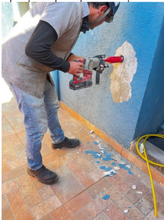
Figura 26 – Preparação de ponto para realização ensaio de aderência
