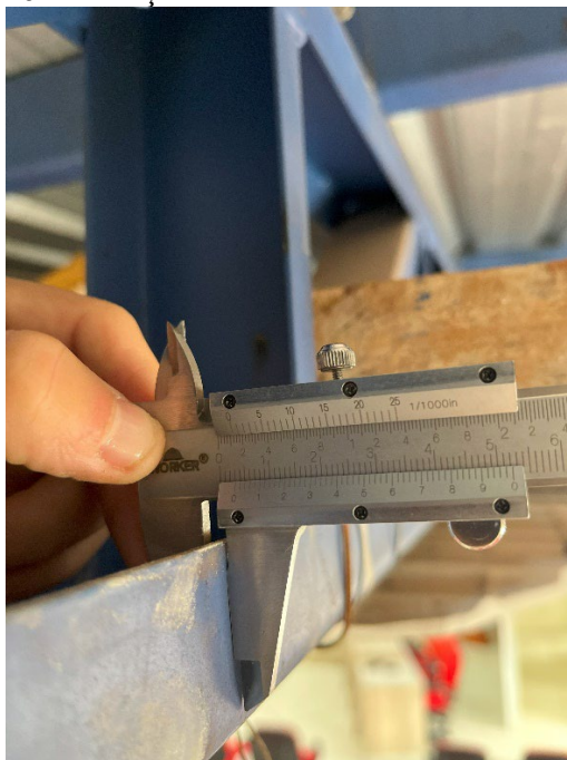
Figura 6 - Aferição das dimensões do banzo inferior
